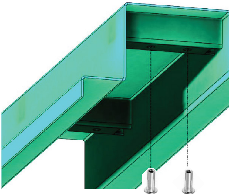
Abbildung 2: Alternativ Ankernietmuttern M10 verwenden
